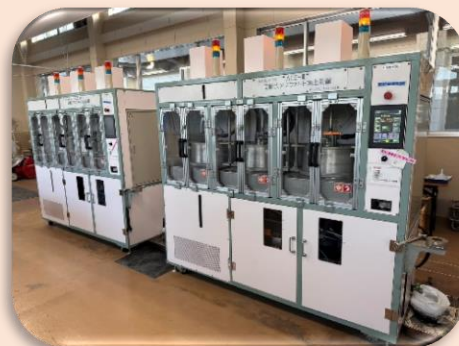
遠心分離型アスファルト抽出機 (試験審査所では2017年より稼働中)
