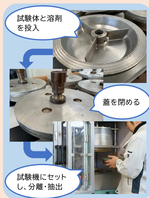
遠心分離型アスファルト抽出機 (試験審査所では2017年より稼働中)
