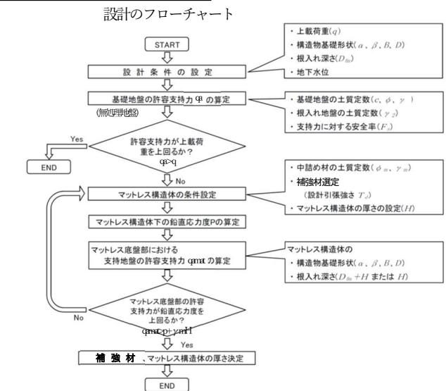
マットレス工法の設計(下図:模式図参照)は、①補強材の引張り力による引き上げ効果と②中詰め材のせん断抵抗によって発揮されるせん断効果、③上載荷重に対するマットレス構造体での荷重分散効果と基礎地盤の許容支持力の関係( $q_{\text{mat}} > p$ (マットレス下面分布圧) +  $\gamma_m \cdot H$ (マットレス自重))から、補強材の選定(設計引張り強さ)とマットレス構造体の厚さを決定します。
