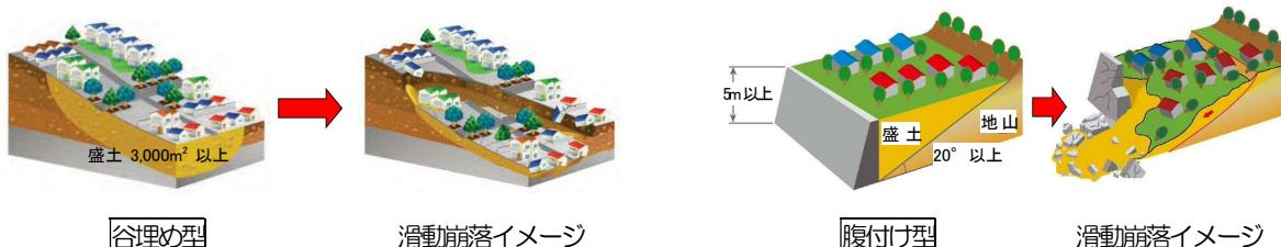
大規模盛土造成地と滑動崩落イメージ
