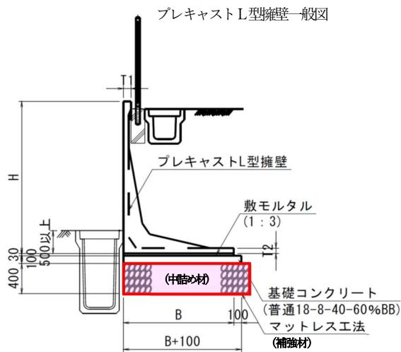
基礎地盤が脆弱な場合に構造物の基礎部を補強材で包み込むことで拘束効果と荷重の分散効果が発揮され、強い地盤をつくり出します。
