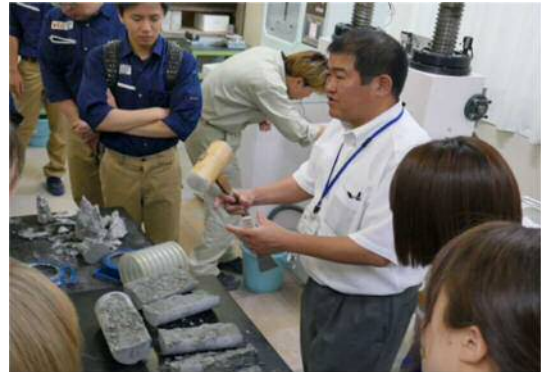
割裂した供試体断面の観察
